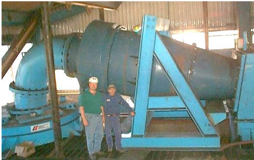
Rys. 4. Hydrocyklon Krebs D40B (Ø 1000mm, 400 t/h, 1999r.)
