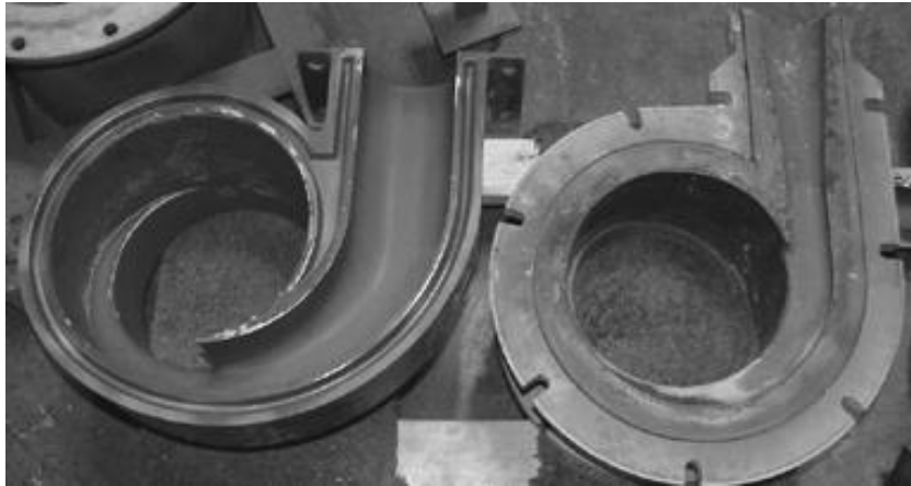
Rys. 5. Porównanie kształtu głowicy wlotowej gMAX (lewa strona) i rozwiązanie konwencjonalne (prawa strona)
