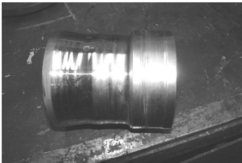
Rys. 2. Typowe zużycie tulei wału w wyniku ugięcia wału.
