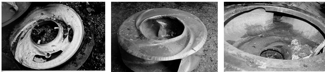
Rys. 5. Zużycie elementów podzespołów komory roboczej spowodowane recyrkulacją wewnętrzną.
