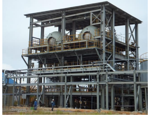
Zdjęcie 1: Filtry tarczowe HiBar (70 m 2 każdy) z kabinami parowymi do filtracji parowo-ciśnieniowej (po lewej); budynek filtrów z dwoma filtrami tarczowymi HiBar o pow. 70 m 2 każdy (po prawej)
