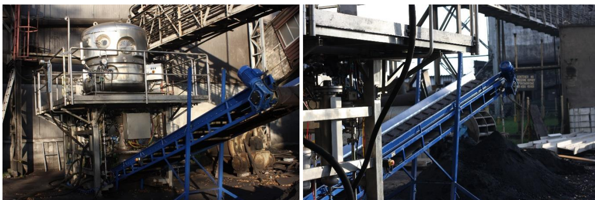
Zdjęcie 2: Jednostka pilotowa HiBar (1m 2 filtr tarczowy) na płucze węglowej KWK Pniówek zawartość wilgoci niezwiązanej placka filtracyjnego poniżej 7% w/w
