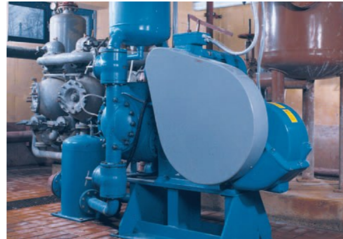
Sprawdzona, trwała konstrukcja. Pompa membranowo-tokowa ABEL CM do zasilania pras filtracyjnych.
