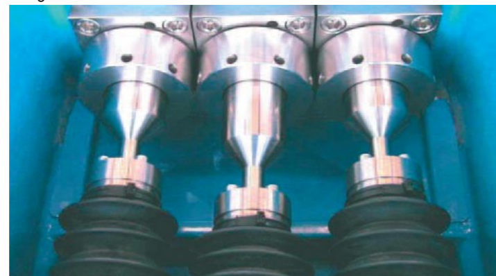
Uszczelnienia/ostony mieszkowe pomp ABEL HPT skutecznie chronią przekładnię przed zanieczyszczeniami pyłami oraz płynami
