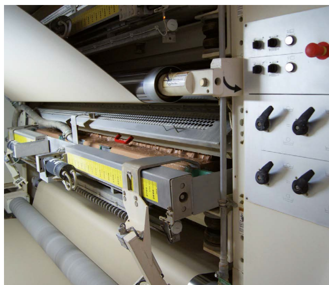
Laminarka maszyny do laminowania fletowego (źródło: VDW)
