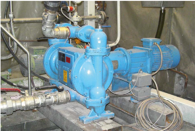
Elektromechaniczna pompa membranowa, typ EM-040Z0300-SG wykorzystywana do recyrkulacji kleju
