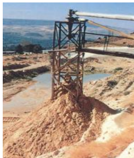
Hydrocyklony odwadniające z przystawką CycloStack™ mogą być montowane na wieżach i estakadach lub nad przenośnikami.
