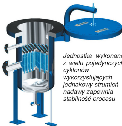
Cyklony firmy KREBS dla zastosowań w przemyśle chemicznym mogą być wykonane z dowolnego metalu i zaprojektowane dla dowolnego ciśnienia i temperatury pracy
