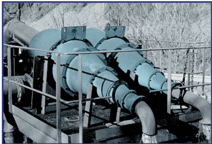
Para cyklonów KREBS z łatwością dokonuje separacji ciała stałe / ciecz dla dużych przepływów wody technologicznej
