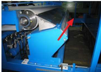
Drugi stopień EMS-C: Zagęszczenie metali do ponad 90% z użyciem separatora z dyszami powietrznymi SGM powietrze doprowadzane od dołu
