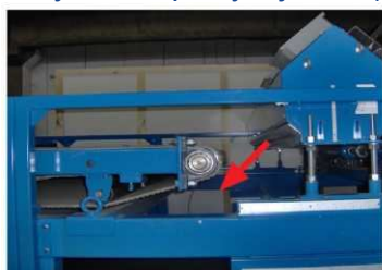
Pierwszy stopień EMS-R: Odzysk wszystkich metali możliwy z użyciem separatora z dyszami powietrznymi SGM powietrze doprowadzane od góry
