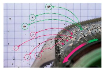
NOT EVERY PIECE OF NON-FERROUS METALS JUMP INSTANTANEOUSLY ON AN ECS, SOME REQUIRE MORE TIME. CONCENTRIC ROTOR DESIGN ALLOWS FOR PROGRESSIVE SEPARATION VERSUS ECCENTRIC ROTOR DESIGN THAT ONLY ALLOWS INSTANTANEOUS SEPARATION.
