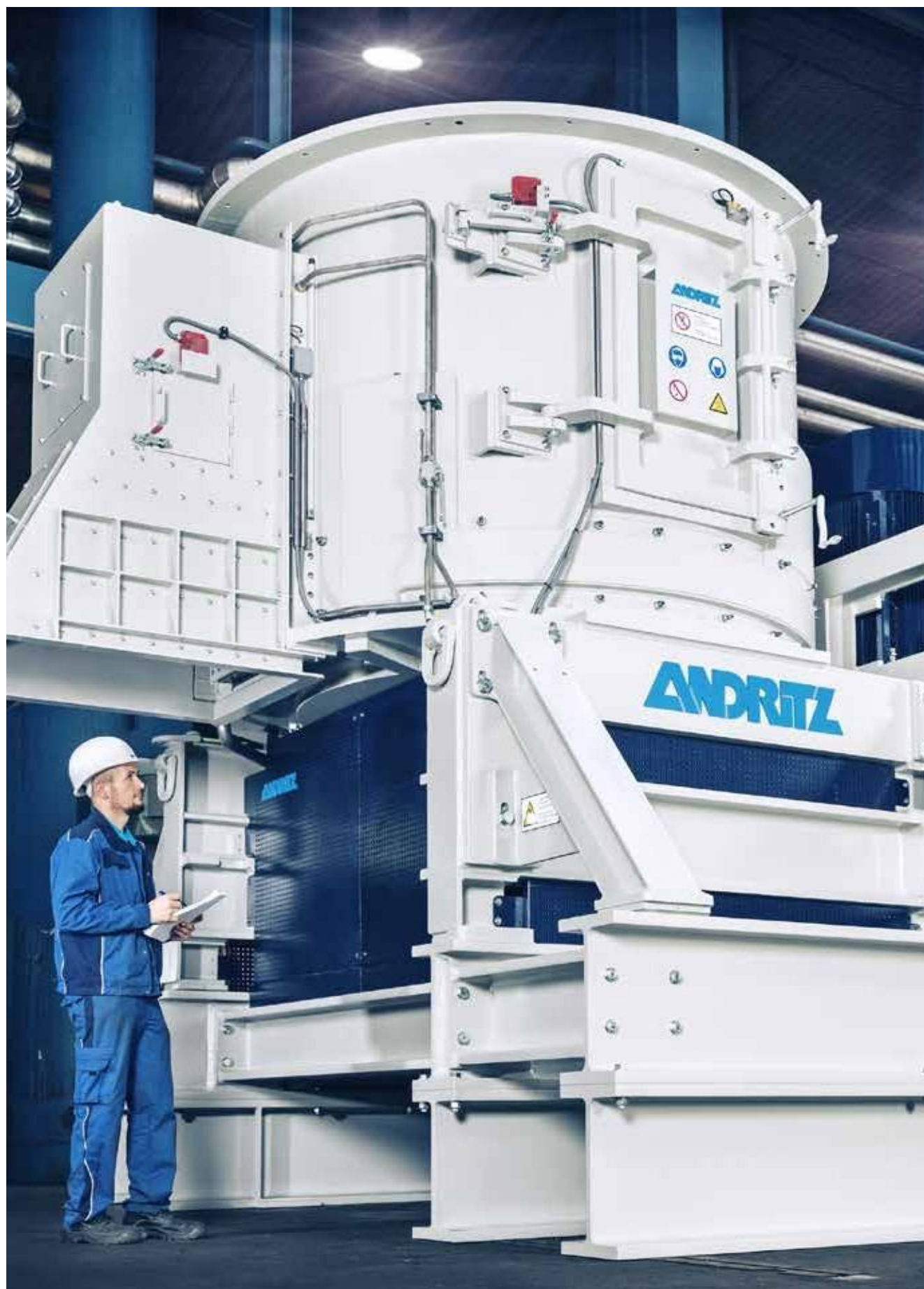
Końcowa kontrola uniwersalnego rozdrabniacza poprzecznego ANDRITZ QZ w warsztacie.
